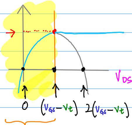
$$V_{ds} \leq V_{gs} - V_t$$
