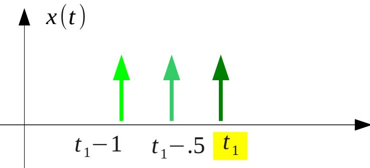
$$x(t) = \delta(t-t_1+1) + \delta(t-t_1+.5) + \delta(t-t_1)$$
