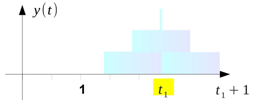
$$y(t) = h(t-t_1+1) + h(t-t_1+.5) + h(t-t_1)$$
