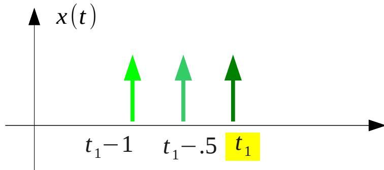
$$x(t) = \delta(t-t_1+1) + \delta(t-t_1+.5) + \delta(t-t_1)$$
