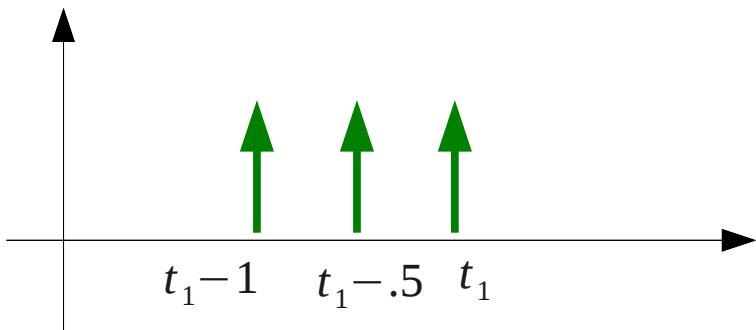
$$x(t) = \delta(t-t_1+1) + \delta(t-t_1+.5) + \delta(t-t_1)$$
